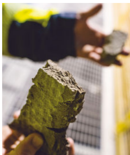
⚠ De uønskede stoffene presses sammen til store filterkaker – og utgjør bare 20 prosent av den totale massen som kommer inn til Rimol. Joakim Sporsheim ved miljøparken viser hvordan kakene produseres.
