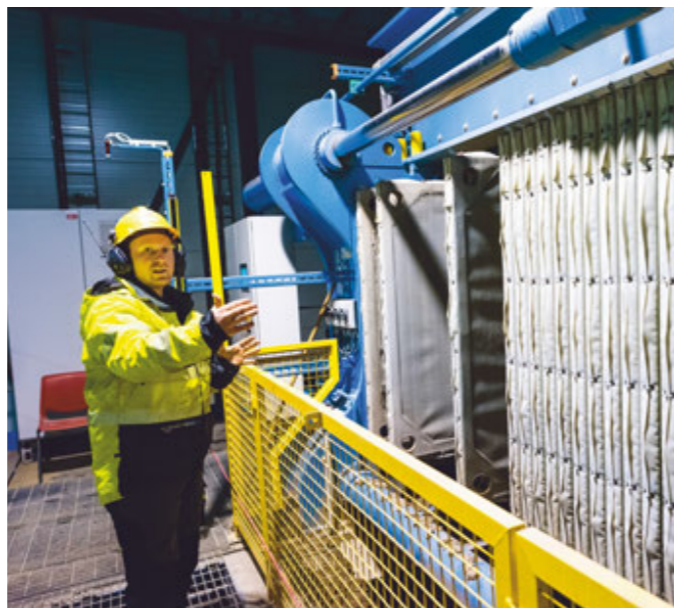
⚠ De uønskede stoffene presses sammen til store filterkaker – og utgjør bare 20 prosent av den totale massen som kommer inn til Rimol. Joakim Sporsheim ved miljøparken viser hvordan kakene produseres.
